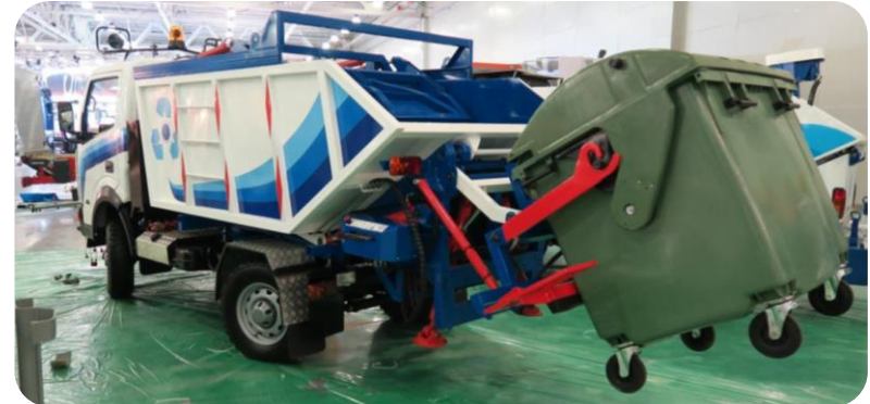
Рис. 37 Механизм опрокидывания контейнеров.
