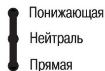
Рис.3.1.3. Схема управления РК кабина комфорт, двигатель бензин
