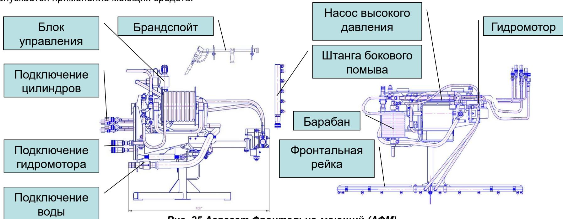
*Рис. 25 Агрегат Фронтально-моющий (АФМ).*
