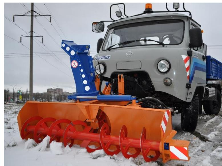
Рис. 31 Шнекороторное оборудование.
