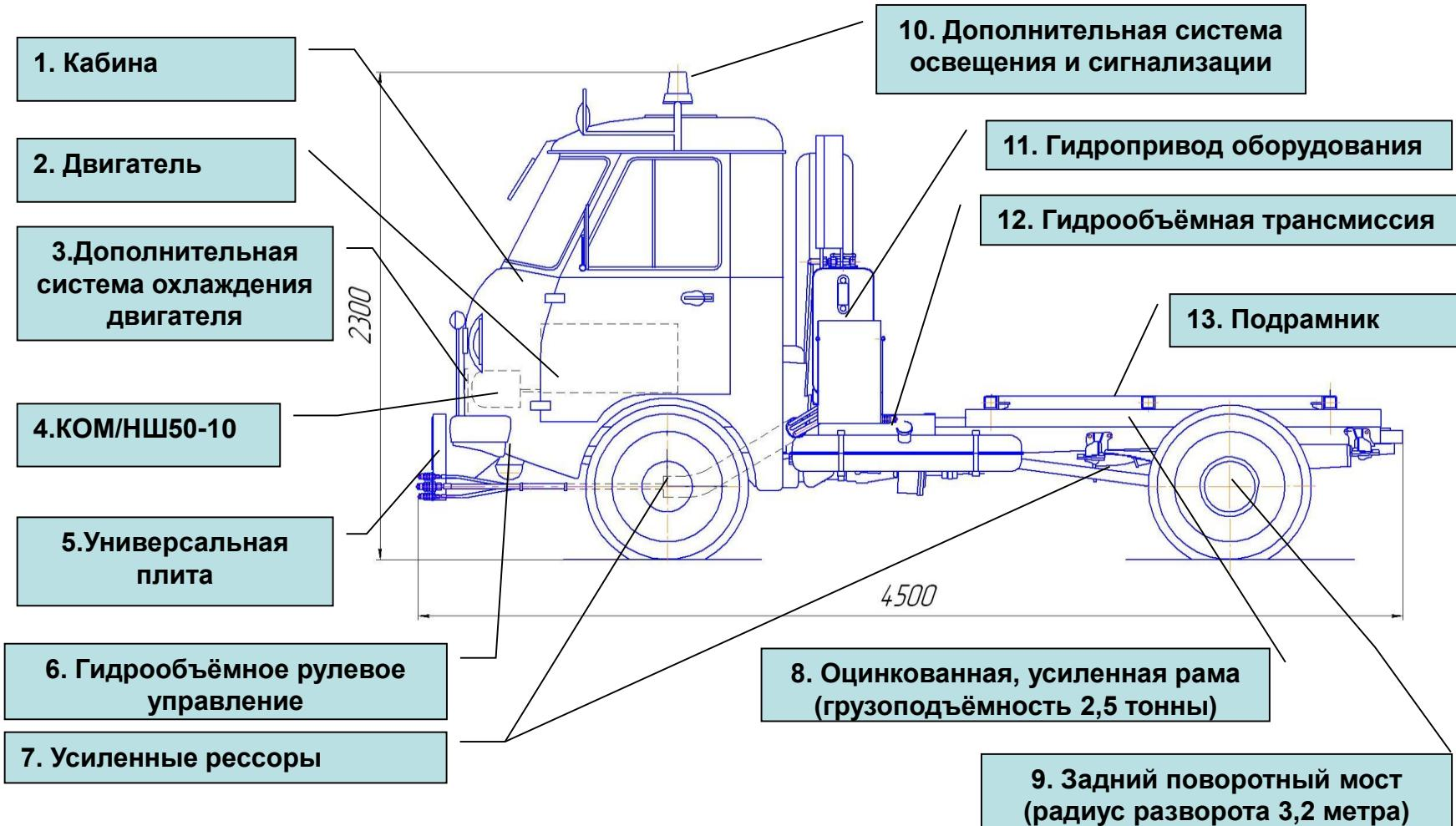
Рис.1. Устройство машины.
