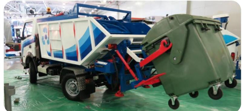
*Рис. 37 Механизм опрокидывания контейнеров.*
