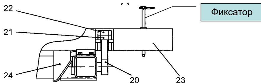
*Рис. 43 Откидной болт*
