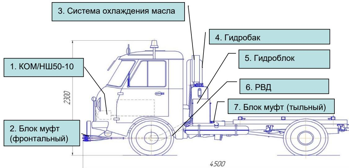
**Рис. 16. Гидропривод оборудования:**
