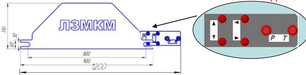
Рис.18. Фронтальная (Передняя) монтажная плита с блоком муфт.
