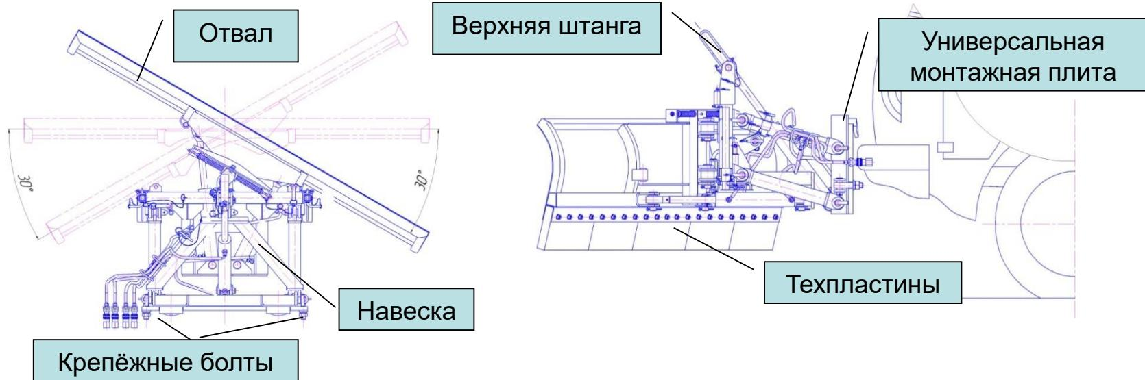
*Рис. 30 Отвал поворотный.*
