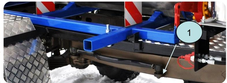
Рис. 14. Аварийная механическая тяга
