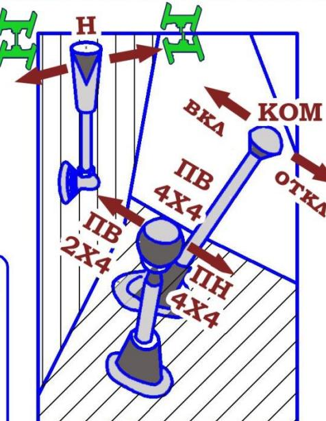
Рис.3 Система рычагов.
