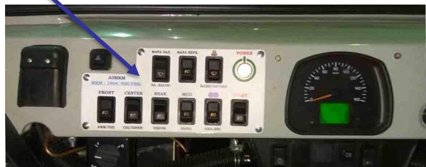
Рис.6. Приборы сигнализации и освещения.
