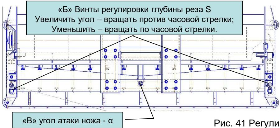
Рис. 41 Регулировка рубанка.
