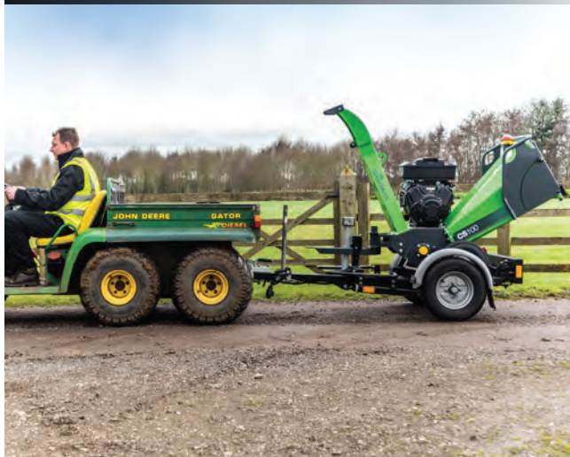
Прицепление для транспортировки в работе
