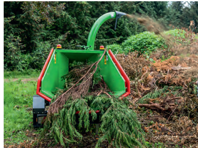
Массивный подающий стол на компактном шасси
