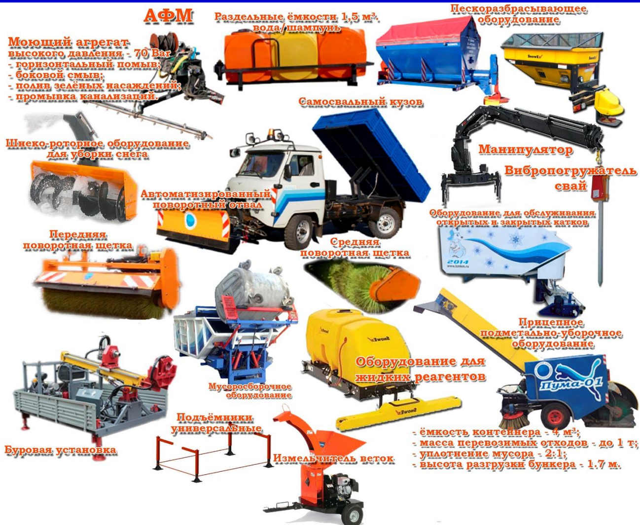
Рис.24 Варианты установки навесного оборудования.
