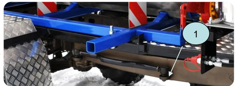
Рис. 14. Аварийная механическая тяга
