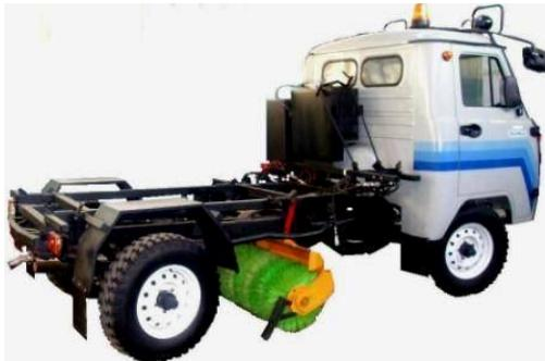
Средняя щётка устанавливается на машину стационарно и может использоваться совместно с другим навесным оборудованием. Клавиши управления щёткой выведены отдельно и позволяют приводить её в транспортное и рабочее положение, а также поворачивать её влево вправо в зависимости от необходимости направления смёта мусора.
