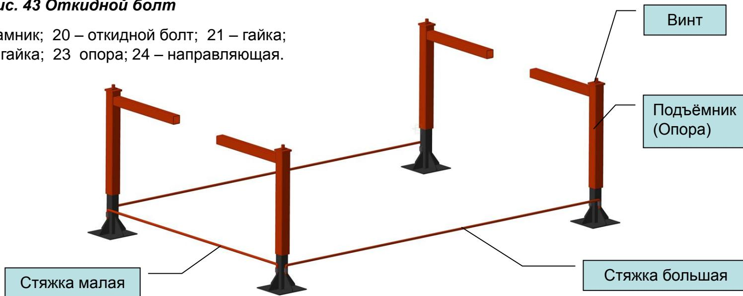
*Рис. 44 Подъёмники механические.*
