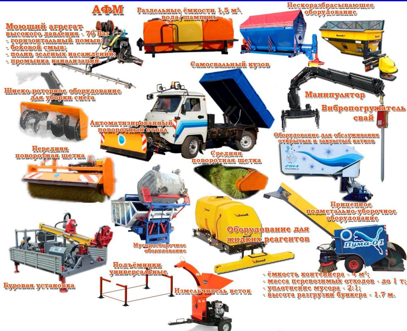
Рис.24 Варианты установки навесного оборудования.
