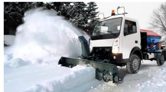
Рис. 31 Шнекороторное оборудование.
