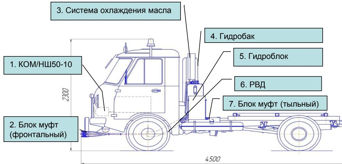
**Рис. 16. Гидропривод оборудования:**
