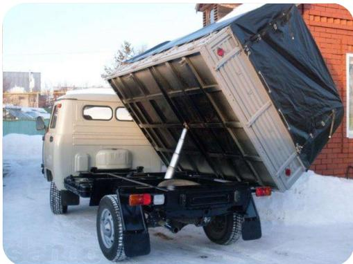
Самосвальный кузов используется для перевозки навалочных, сыпучих и иных грузов.
