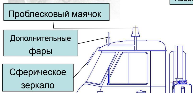
Рис.6. Приборы сигнализации и освещения.
