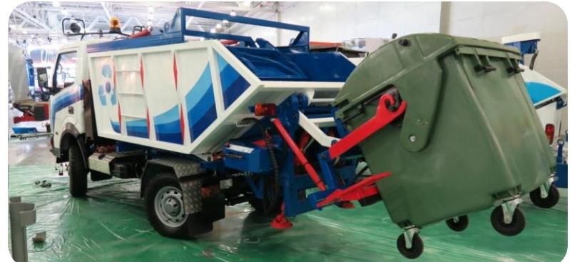
*Рис. 37 Механизм опрокидывания контейнеров.*
