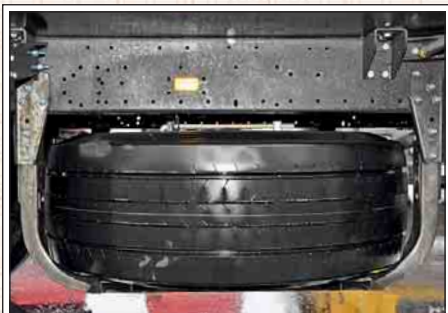
КОРЗИНУ для запасных колес пришлось доработать с учетом размещения «суперсингла».
