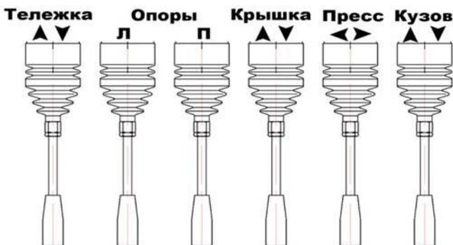
Перед выгрузкой мусора необходимо опустить опоры на деревянные щиты и разгрузить заднюю ось машины. Убедиться в отсутствии воды в бункере, при необходимости открыть сливную крышку и слить воду. Поднять крышку вверх, после чего поднять кузов и приступить к выгрузке мусора. Для увеличения высоты подъёма бункера необходимо переместить тележку вверх соответствующим рычагом на блоке управления. Опускание кузова происходит в обратной последовательности.
