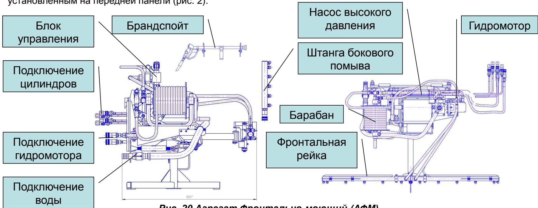
**Рис. 20 Агрегат Фронтально-моющий (АФМ).**
