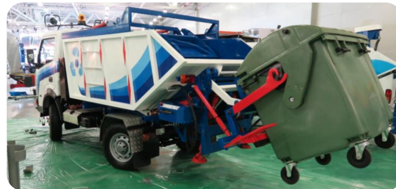
Рис. 37 Механизм опрокидывания контейнеров.
