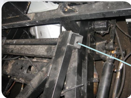
Рис. 35 Кронштейн крепления СК.
