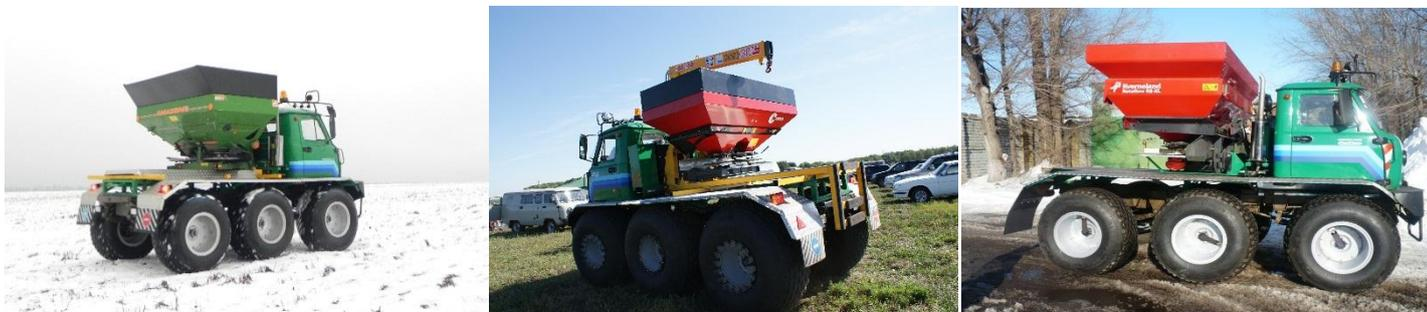
Разбрасыватель минеральных удобрений предназначен для поверхностного внесения подкормочных доз твёрдых минеральных удобрений в гранулированном и кристаллическом виде.
