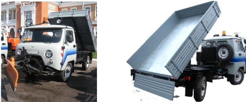
Рис.4 – Машина МПМ-1500 в летней комплектации с передним щеточным оборудованием и зимней комплектации с пескоразбрасывающим оборудованием.
