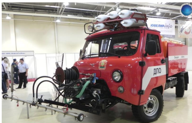
Рис.2 – Машина МПМ-1500 с установкой многозалпового порошкового пожаротушения (УМПП).
