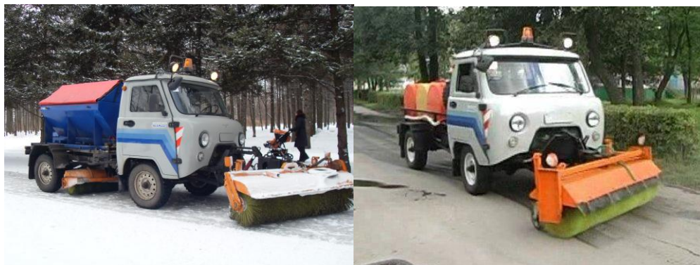
Рис.4 – Машина МПМ-1500 в летней комплектации с передним щеточным оборудованием и зимней комплектации с пескоразбрасывающим оборудованием.
