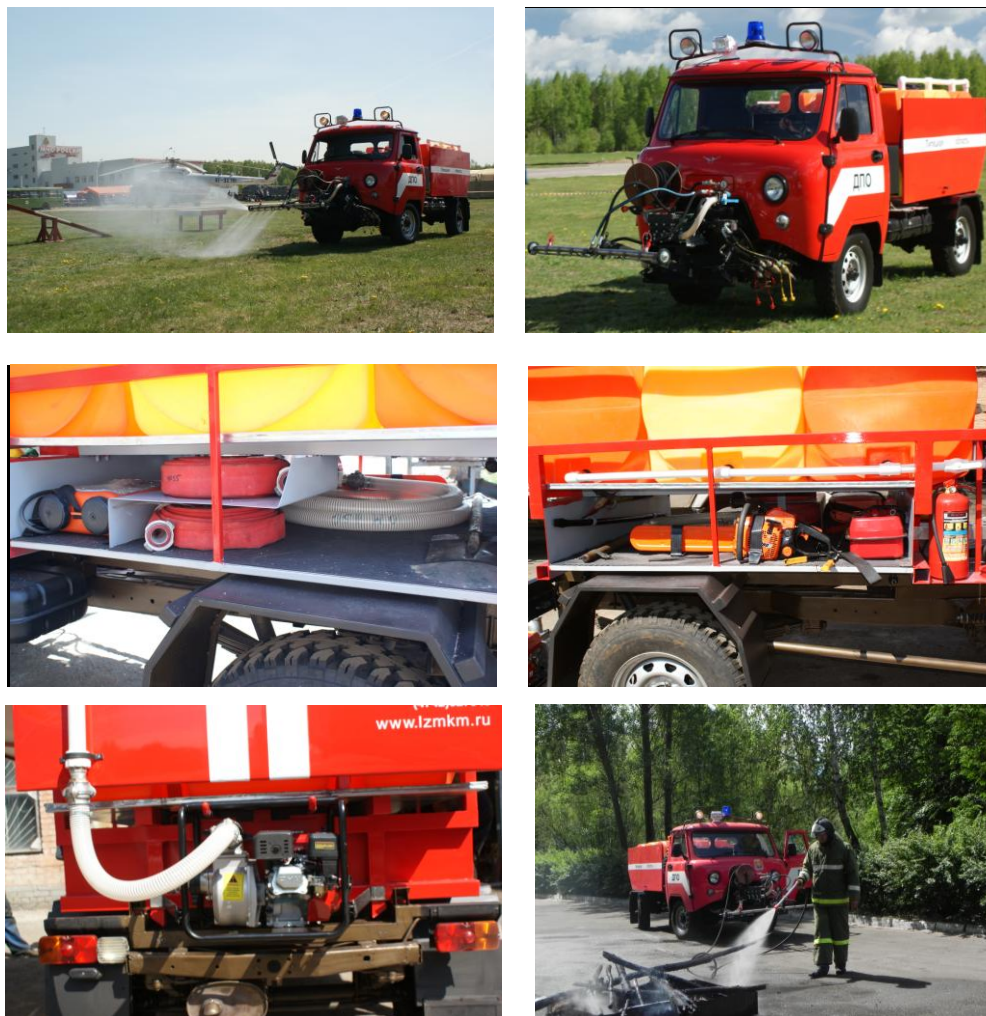
Рис.1 – Машина МПМ-1500 с комплектом специального пожарного оборудования.
