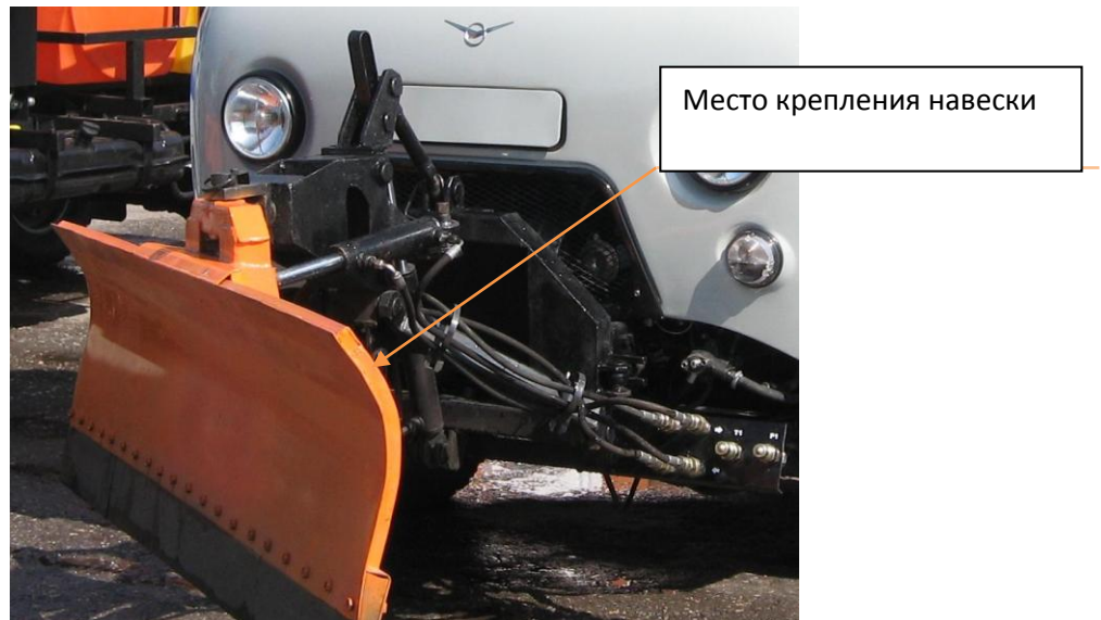
Рис.16-крепление навески на монтажной плите
