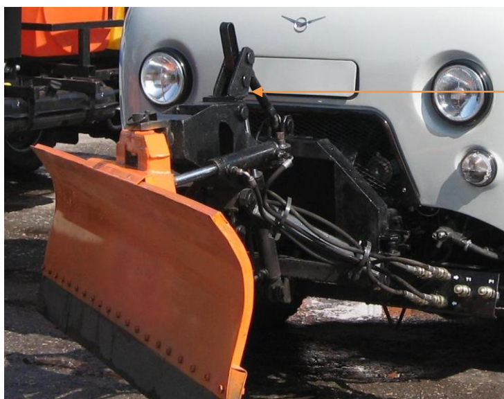
Рис.18 – верхняя штанга регулировки высоты и угла плуга.
