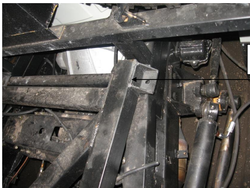
Кронштейн крепления кузова к раме
