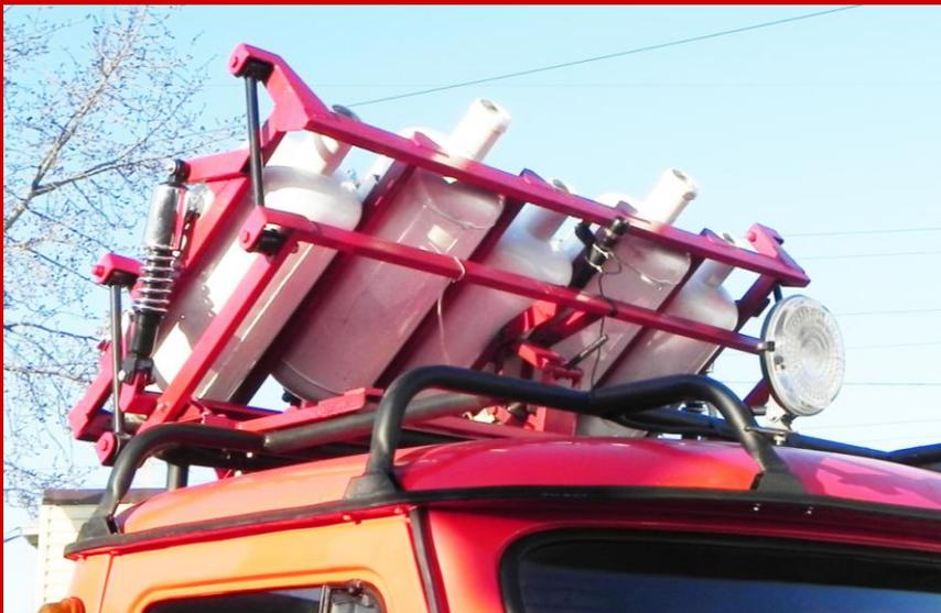
Для тушения пожаров порошком над крышей машины расположена установка для залпового порошкового пожаротушения (УМПП-5) состоящая из 5-ти модулей.
