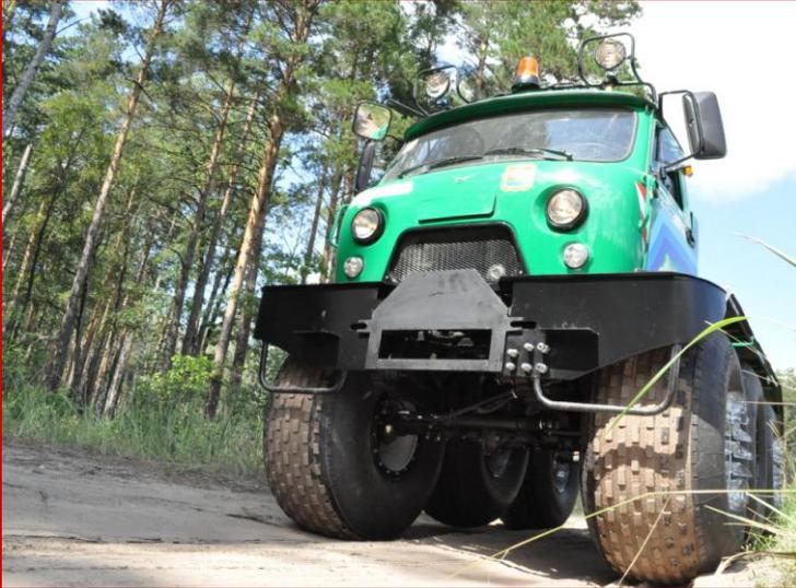
Данная модель вездехода разработана на базе серийно выпускаемой модели, с модернизированным трехосным шасси, на шинах сверхнизкого давления, что позволяет использовать данную машину в любой период времени года.
