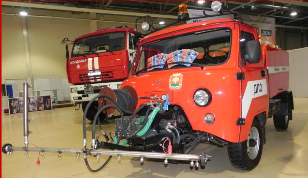
Для тушения пожаров водой, во фронтальной части машины установлен насос высокого давления производительностью 120 л/мин, который обеспечивает подачу воды в легкосъёмную водораздающую рейку (для тушения ландшафтных пожаров), с устройством бокового напора для смачивания самой машины при её непосредственной близости к очагу возгорания и пистолет (брендспойт).
