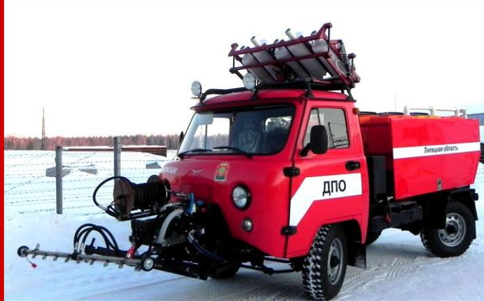
Самостоятельная боевая единица, служащая не только для патрулирования лесных хозяйств, но и для доставки к месту пожара пожарного расчета (1+1), запаса огнетушащих веществ (вода 1,5 куб.м и порошковые модули (Тунгус-24)) и комплекта пожарнотехнического вооружения (ПТВ), что мгновенно позволяет потушить распространяющийся пожар и не допустить более масштабные возгорания
